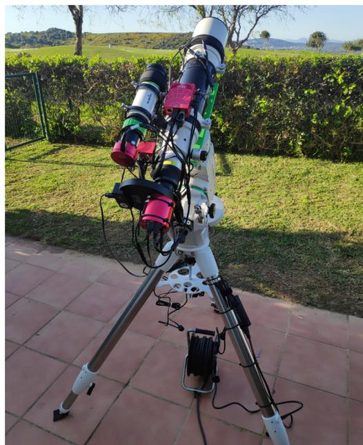
Figura 4: Tubo 80ED-PRO Black Diamond de Skywatcher con su correspondiente reductor/corrector 0.85x + rueda porta filtros + cámara refrigerada monocroma ZWO ASI1600MM Pro. En paralelo: tubo de guiado 50ED EVO-GUIDE de Skywatcher + cámara monocroma ZWO ASI290MM. Ambos trenes ópticos están instalados sobre una montura AZ-EQ6 SynScan de Skywatcher.
